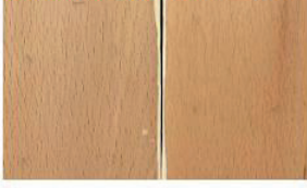
Dış ortam testi öncesi vernik uygulanmış sarıçam odunu yüzeyi
