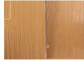
Dış ortam testi sonrası vernik uygulanmış sarıçam odunu yüzeyi
