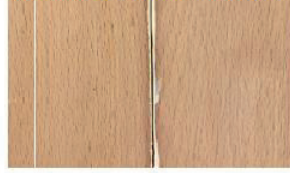
Dış ortam testi sonrası vernik uygulanmış sarıçam odunu yüzeyi
