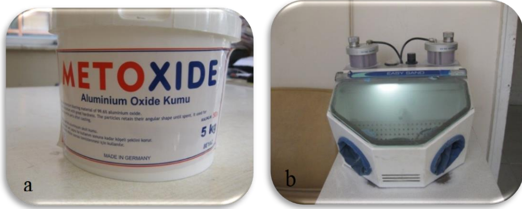
Resim 7. Kumlama işlemi amacıyla kullanılan alüminyum oksit tozu ve kumlama cihazı. A: 50 µm alüminyum oksit tozu, b: Kumlama cihazı
