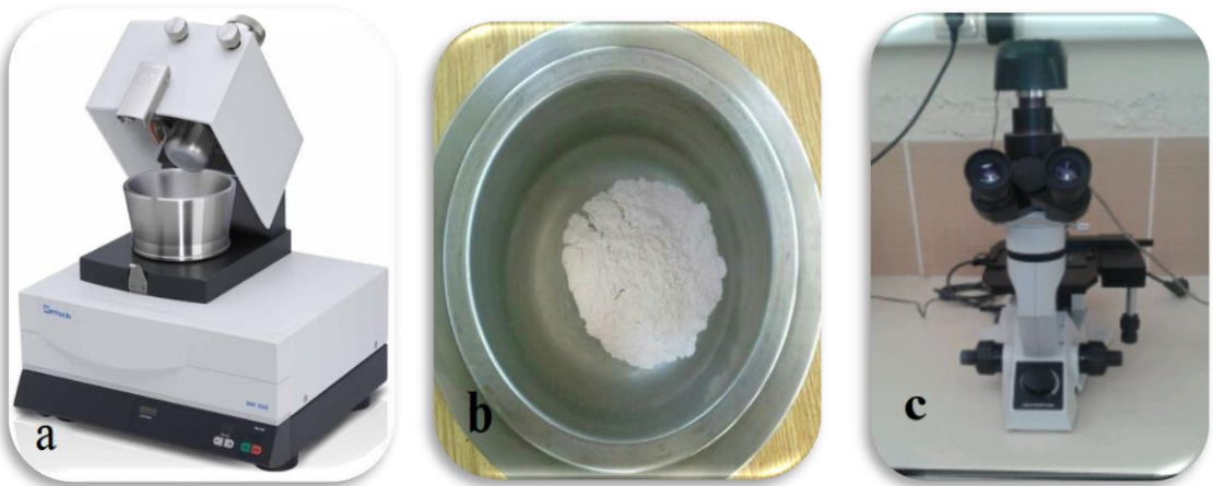
Resim 9. Zirkonyum oksit tozunun elde edilmesi için kullanılan cihaz ve elde edilen tozun görüntüsü. A.Milled makinesi, b:Zirkonyum oksit tozu, c:Işık mikroskobu
