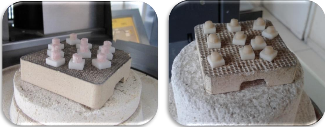
Resim 20. Hazırlanan örneklerin seramik fırınında pişirilmesi
