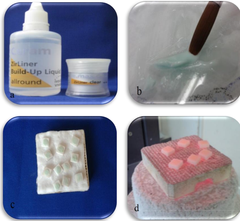
Resim 13. Liner materyalinin hazırlanması. A: Kullanılan liner materyalinin toz ve likiti, b: Toz ve likitin karıştırılması, c: Uygulanması, d: Fırınlanması
