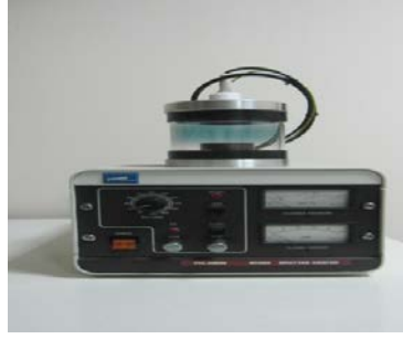
Resim 16. Örneklerin altınla kaplanmasında kullanılan (Polaron Sputter Coater SC502, East Sussex, İngiltere) cihazının görünümü
