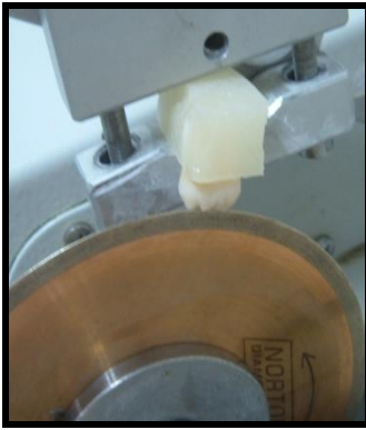
Resim 16, 17: Mine dokusunun elmas separe ve düşük hızlı kesme cihazı ile su soğutması altında uzaklaştırılması sonrası bukkal yüzeyi açığa çıkmış dentin örneği
