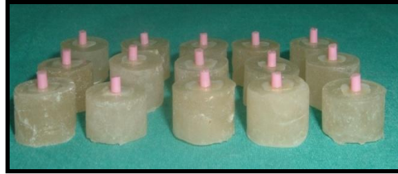
Resim 21, 22: Dentin yüzeylerine silindirik uçlardan kompozit rezin uygulaması sonrası her grupta n=15 olacak şekilde hazırlanan örnekler
