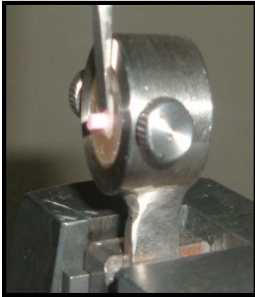
Resim 24, 25: Dentin örnekleri test cihazının model tutucuları arasında bağlantı yüzeyleri yer düzlemine dik olacak şekilde sabitlendi.
