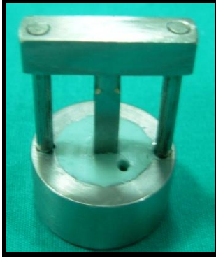
Resim 10: Hidrofilik vinil silikon ölçü maddesi ile metal çubuğun etrafının tamamen doldurulması
