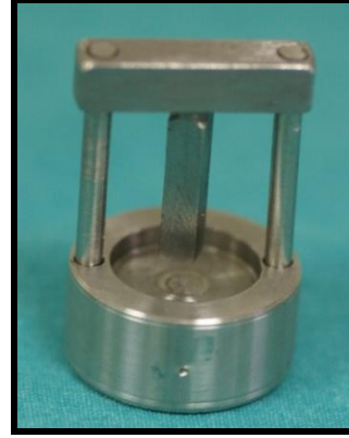
Resim 6, 7: Dentin disklerinin yerleştirilmesi için tasarlanan aparat
