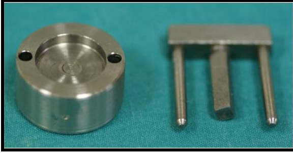
Resim 6, 7: Dentin disklerinin yerleştirilmesi için tasarlanan aparat
