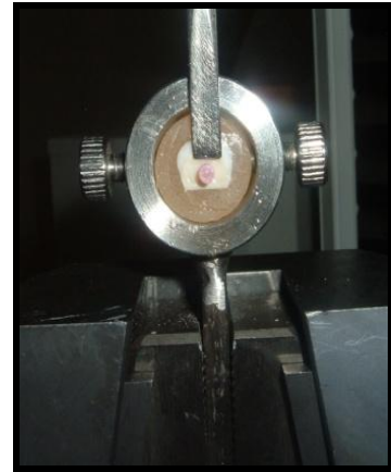
Resim 24, 25: Dentin örnekleri test cihazının model tutucuları arasında bağlantı yüzeyleri yer düzlemine dik olacak şekilde sabitlendi.
