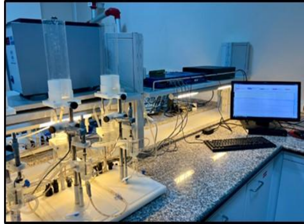
Resim 3. Dokulardaki gerilim değişiklikleri izometrik kuvvet transdüseri aracılığı ile ölçülmesi
