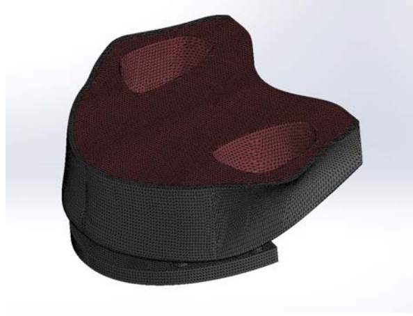
Şeki 14. Oluşturulan ve bar ataçman yerleştirilen atrofik maksilla modelinde ağ (Mesh) görüntüsü
