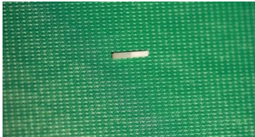
Resim 14. Mikrogerilim testleri için elde edilen dentin çubuğu örneği
