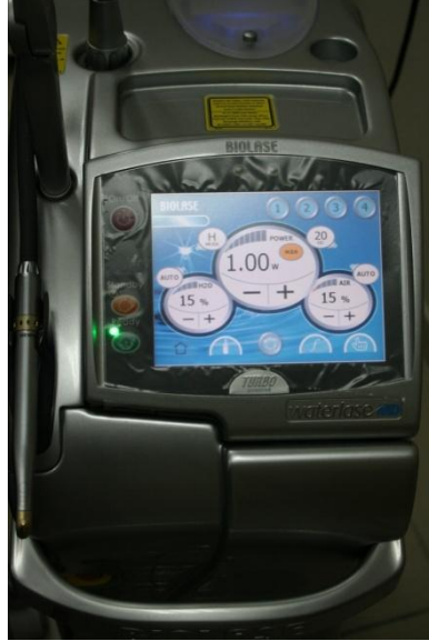
Resim 2. Çalışmada kullanılan Waterlase Er,Cr:YSGG Lazer cihazı
