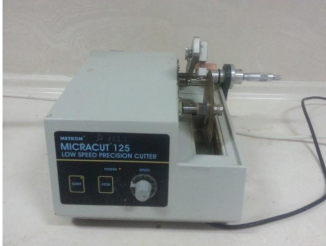
Resim 13. İsetmet cihazı ile kesitlerin alınması
