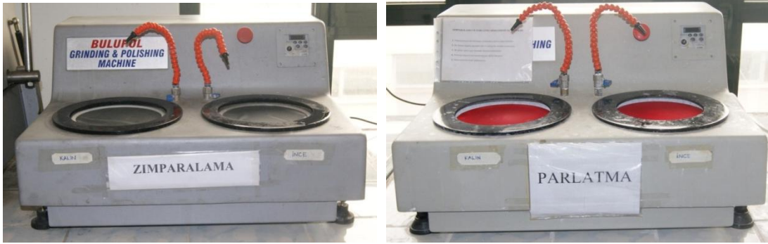
Resim 16. Zımparalama ve parlatma işlemleri sırasında kullanılan cihazlar
