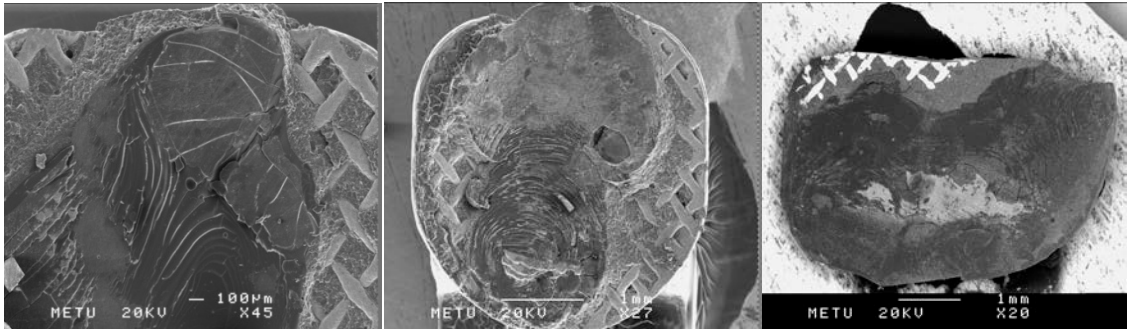
Resim 20. Braket tabanından değişik büyütmelerde alınan SEM görüntüleri
