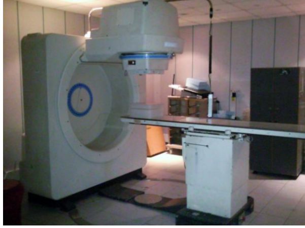
Şekil 11. Fibroblast hücre serilerinin ışınlanmasında kullanılan ^{60}\text{Co} radyoaktif kaynaklı teleterapi cihazı
