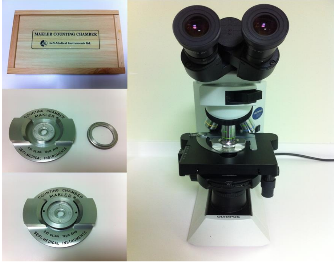
Resim 5. Makler sayım kamerası ışık mikroskobu ve sperm sayımı
