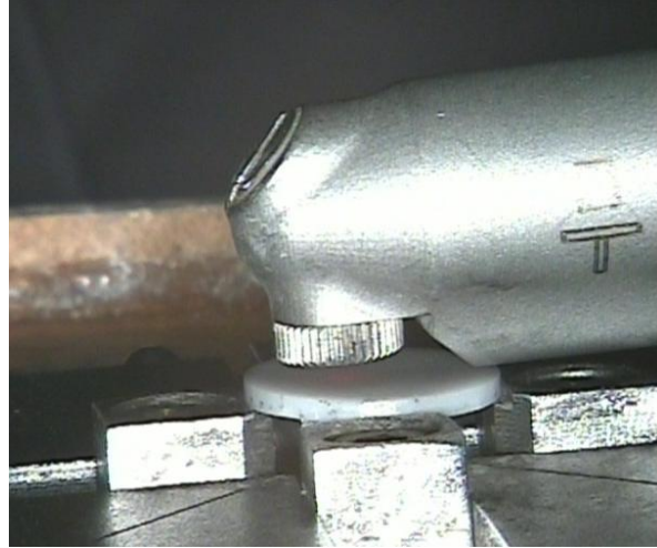
Resim 10. Lazer cihaz ucunun örnekle arasındaki mesafe
