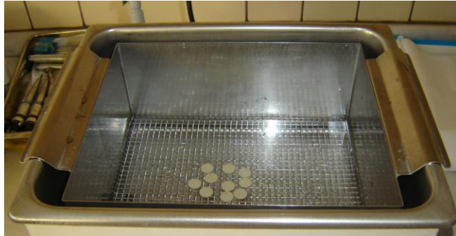
Resim 12. Yüzey ve ısıl işlem uygulanan örneklerin ultrasonik banyoda temizlenmesi
