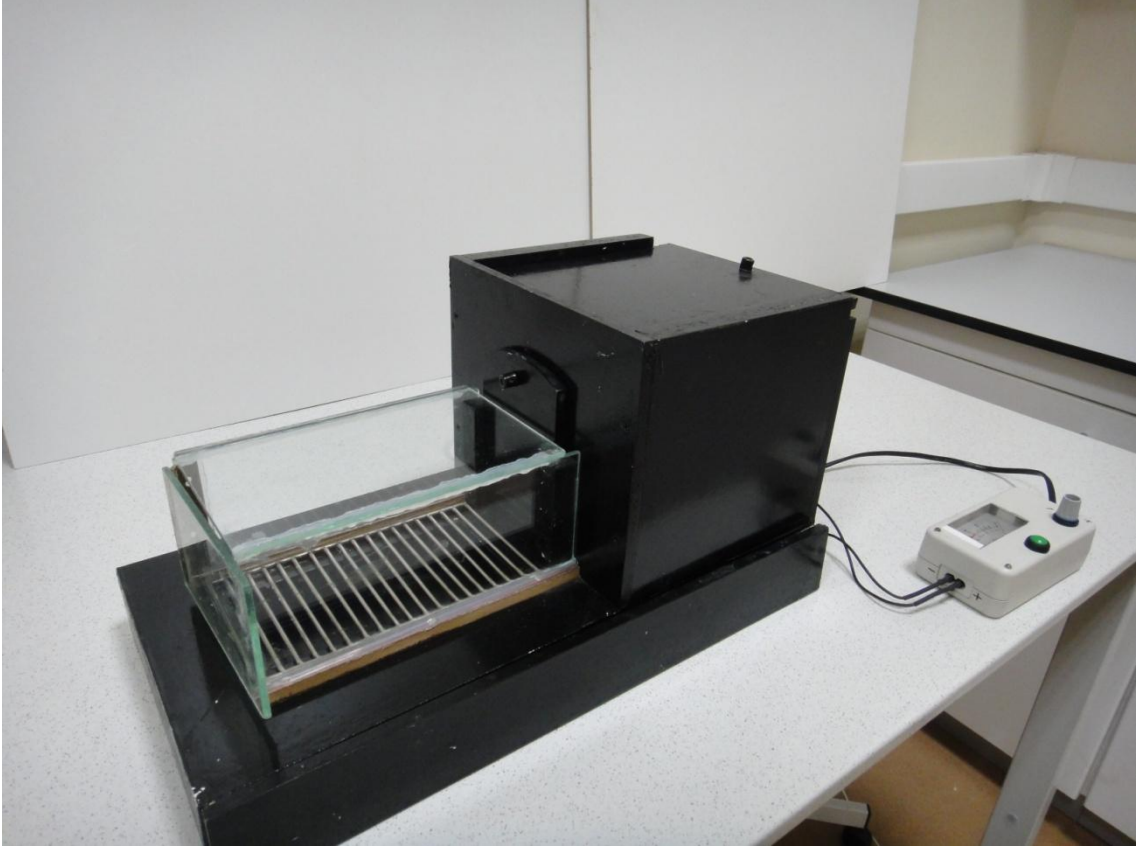
Şekil 7: Pasif sakınma deney düzeneği
