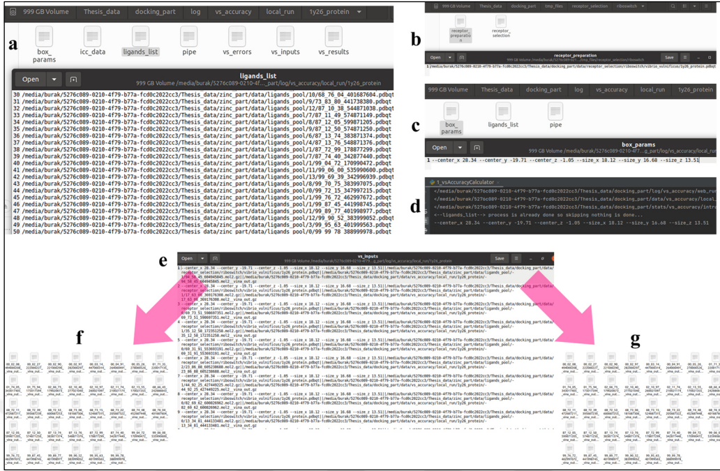
Resim 62. Sanal tarama analizi için aday reseptör dosyalarından seçim yapılması ve seçilen dosya içeriğinin analiz için hazır hale getirilmesi süreci. (a) “ ligands_list ” dosyası (b) “ receptor_preparation ” dosyası (c) “ box_params ” dosyası (d) Kod betiği çalışma sürecinden bir kesit. (e) “ vs_inputs ” dosya içeriğinden bir kesit. (f) “ local_run ” sonuç dosyalarından bir kesit. (g) “ web_run ” sonuç dosyalarından bir kesit.
