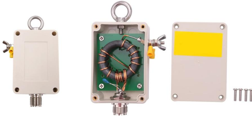
Şekil 2-1. Örnek bir UnUn montajı ve kutulaması: kapalı kutu (solda), kapağı açık kutu içinde toroid nüve ve sargılar (ortada), kapak ve vidalar (sağda).
