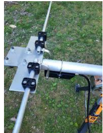
Şekil 1-3. Yagi Driven Element (Besleme Elemanı) için faydalı resimler: Yagi anten besleme teknikleri (driven elemanın besleme noktasında kutu, konnektör ve bağlantı düzenlerine ait örnek fotoğraflar).
