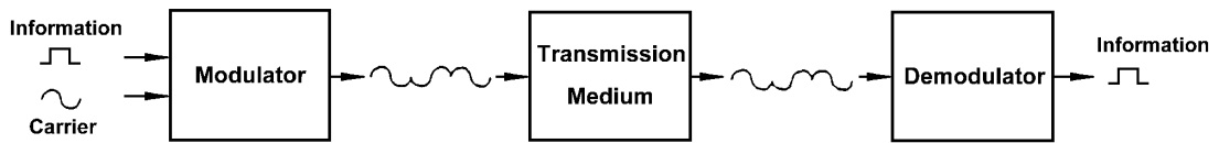
Fig. 19-3 PSK/QPSK sisteminin blok diyagramı.
