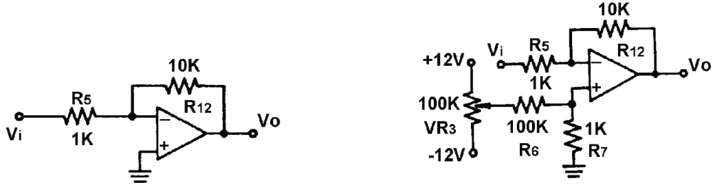
Şekil 5-9. Eviren yükselteç devreleri: (a) ofset ayarsız, (b) ofset ayarlı.
