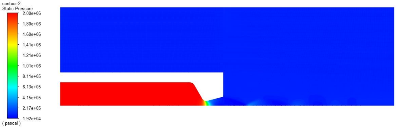
Şekil 45. İtki odası ve çıkışındaki statik basınç dağılımı
