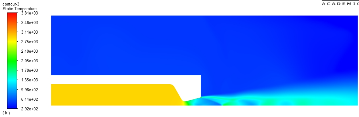
Şekil 46. İtki odası ve çıkışındaki sıcaklık dağılımı
