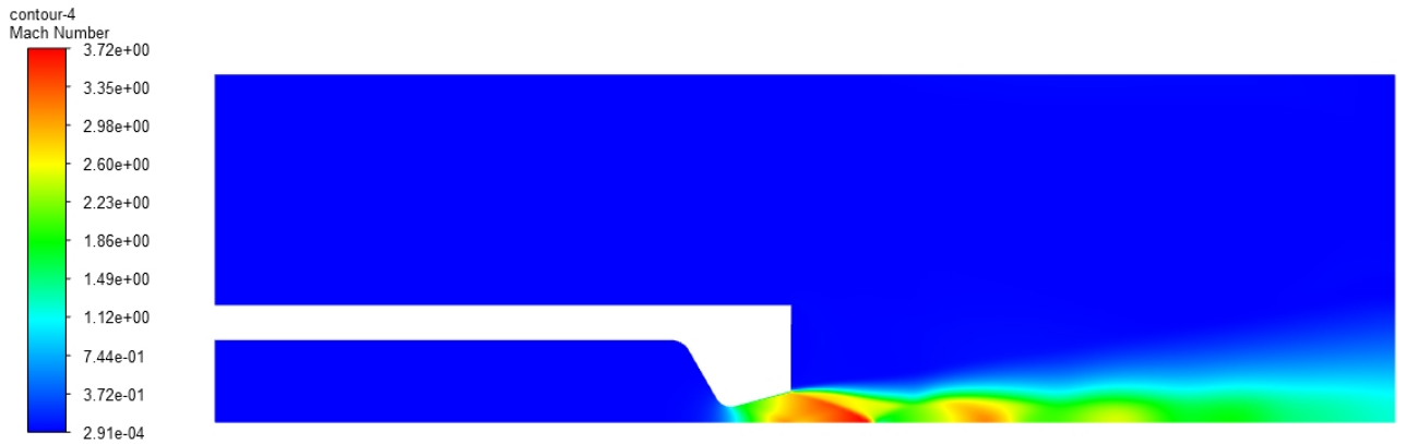
Şekil 43. İtki odası ve çıkışındaki Mach Sayısı dağılımı
