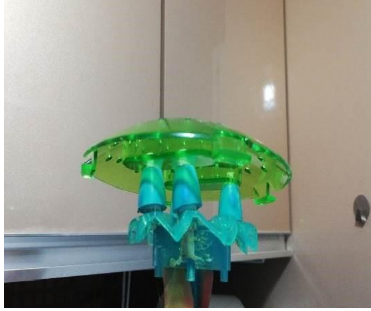
Şekil 7 Küre – teker arası bağlantı montajı
