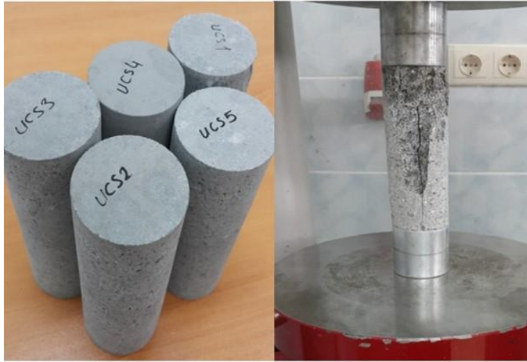
Şekil 4. Tek eksenli basınç dayanımı numune ve kırılma anı
