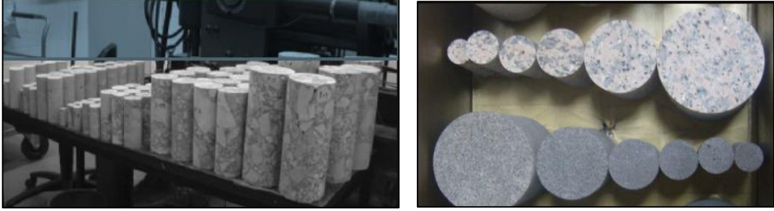
Şekil 3. Farklı boyutta karot örnekleri.
