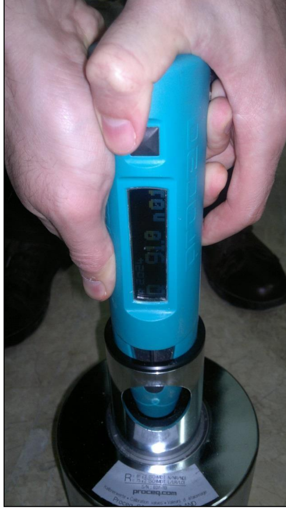
řekil 4. Dijital Schmidt çekici kalibre edilirken
