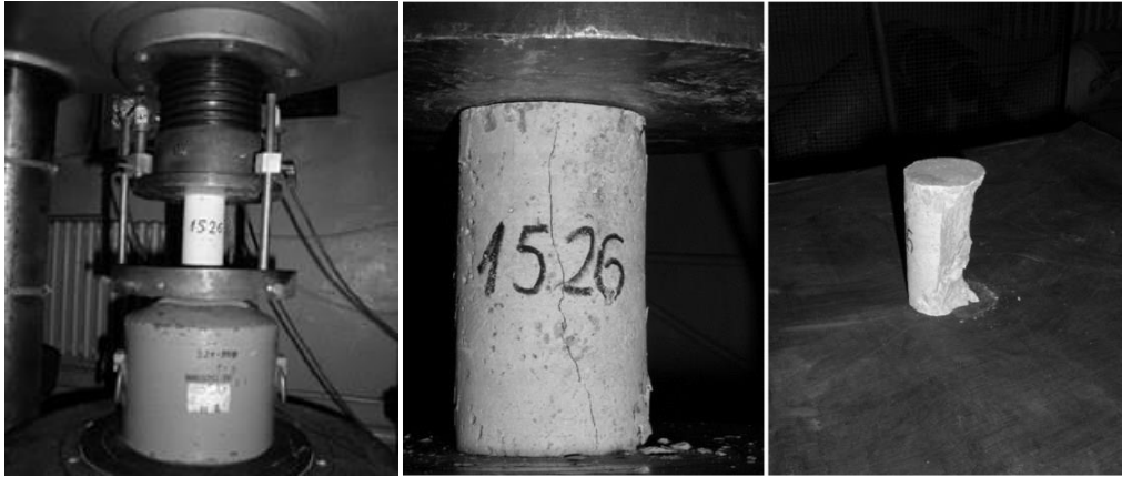
Şekil 1. Tek eksenli basınç dayanımı test ünitesi ve kırılma sonrası numune görünümü
