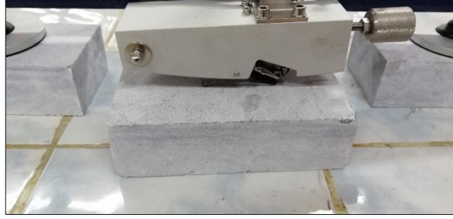
Şekil 1. 4S (dar) kaydırıcının görünümü (sol) ve kaydırıcının numune üzerindeki hareketi (sağ)
