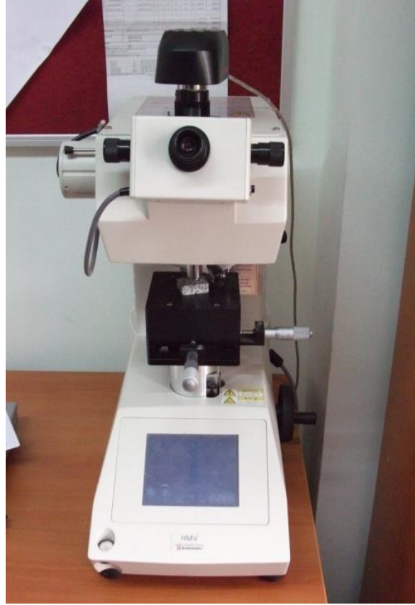
Şekil 6. Shimadzu marka mikro-sertlik cihazı
