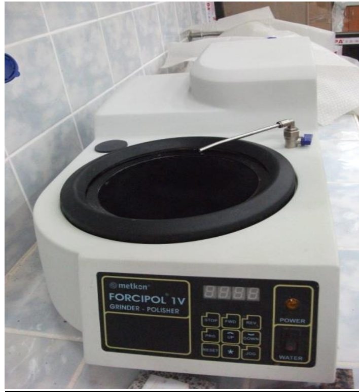
Şekil 5. Metkon Numune Parlatma Cihazı
