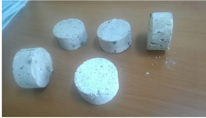
Şekil 1: Disk şeklinde kayaç numuneleri
