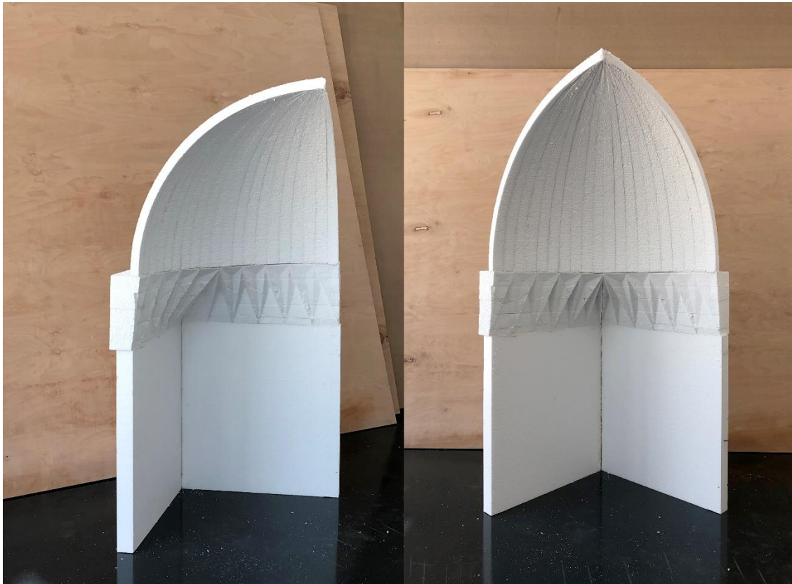
Şekil 9: 1/10 ölçekli EPS malzemeden üretilmiş Bursa Hacılar Cami köşe modeli
