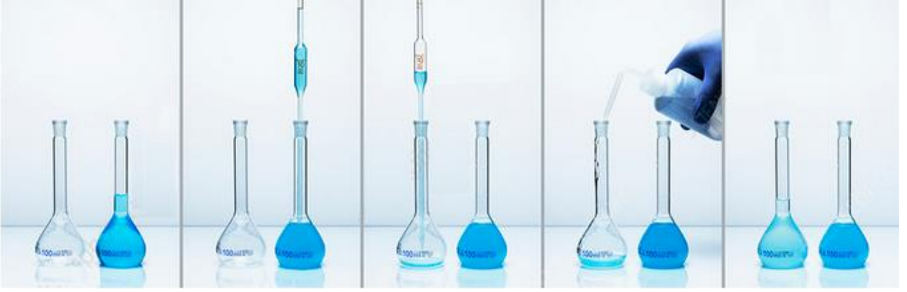
Şekil 3. Sıvılardan seyreltme ile çözelti hazırlama aşamalarının gösterimi
