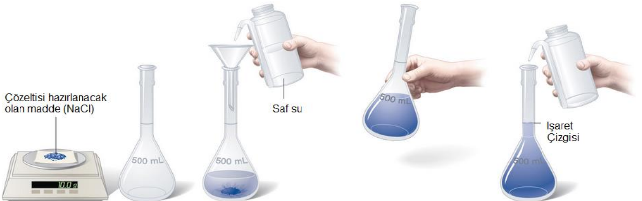
Şekil 2. Katı maddelerden çözelti hazırlama aşamalarının şematik gösterimi
