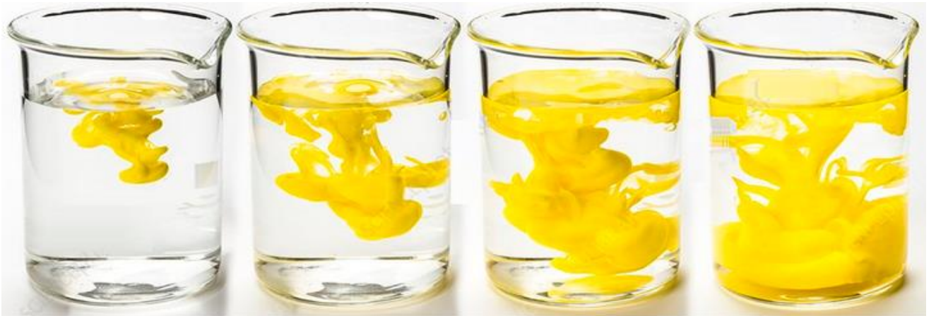
Şekil 5. \text{PbI}_2 'ün çöktürülmesi aşamaları
