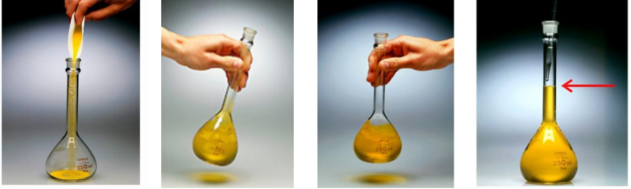
Şekil 1. Çözelti hazırlama aşamaları
