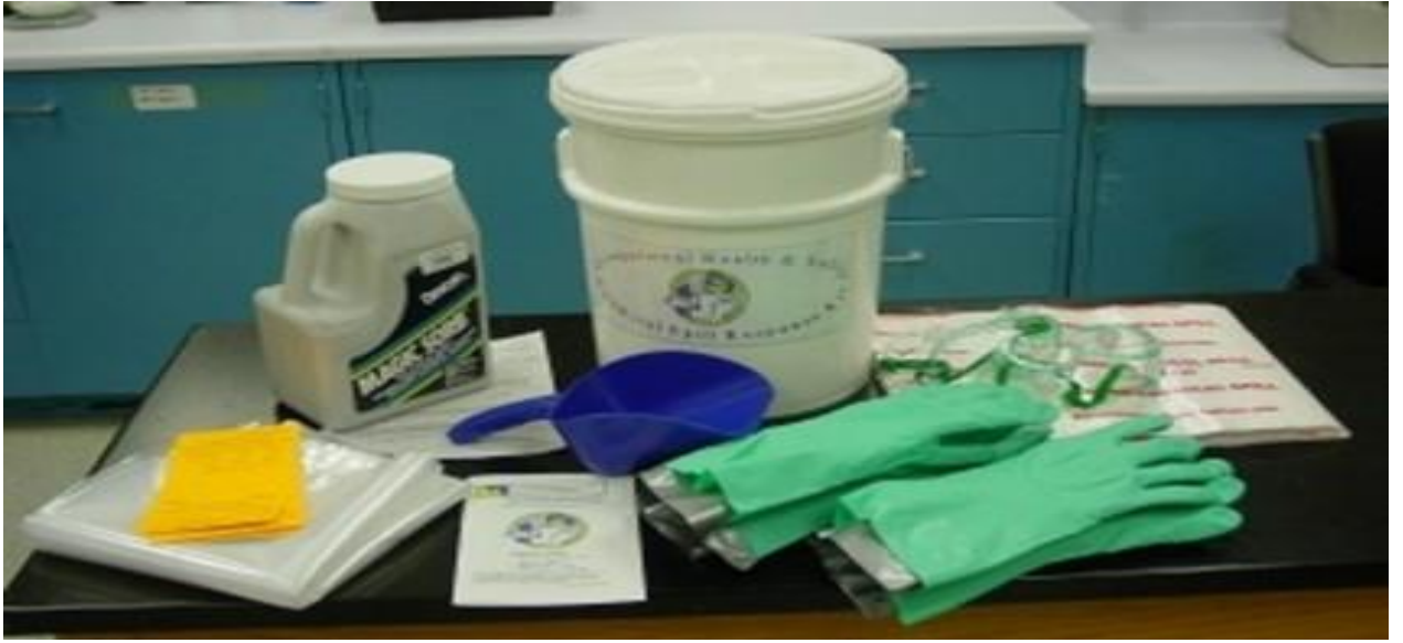
Şekil 2. Kimyasal Dökülme-Saçılma Kit İçeriği
