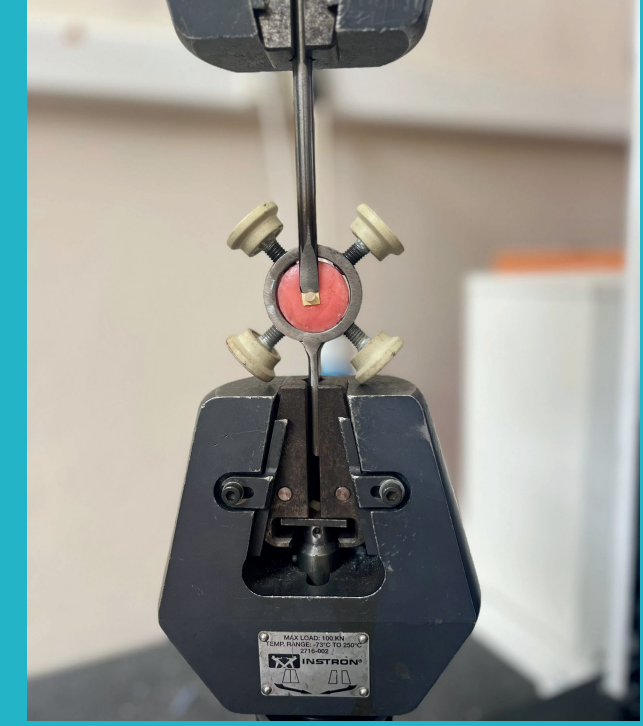
Resim 6. Makaslama bağlanma dayanım testinin uygulanması
