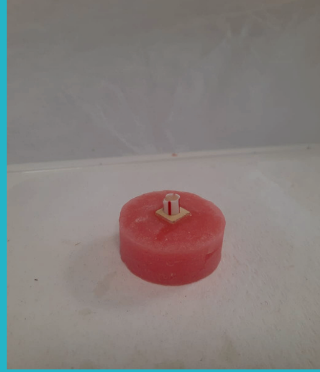
Resim 4. PEEK örneğinin orta yüzüne kalıp vasıtasıyla 4x5 mm kompozit rezin uygulanması
