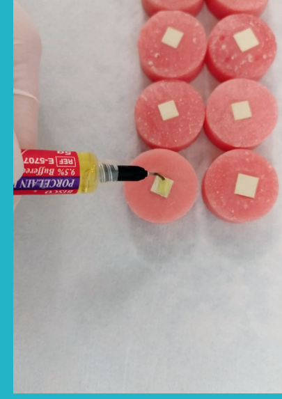
Resim 3.b. Hidroflorik asit uygulaması
