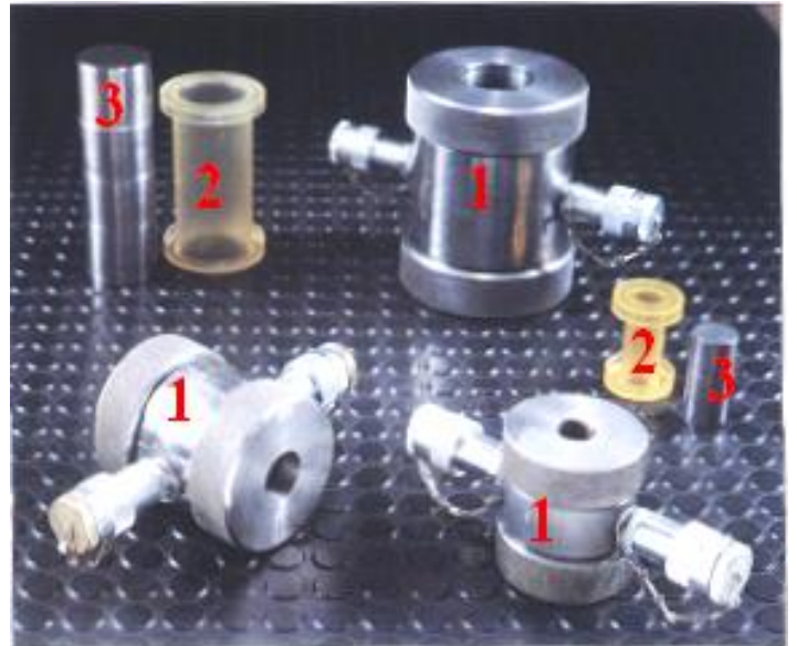
Şekil 2: (a) Üç eksenli deney hücresinin (Hoek Hücresi) şematik görünümü ve (b) çeşitli çaplardaki karotlar için Hoek hücreleri(1), kılıflar (2) ve küresel başlıklar (3).
