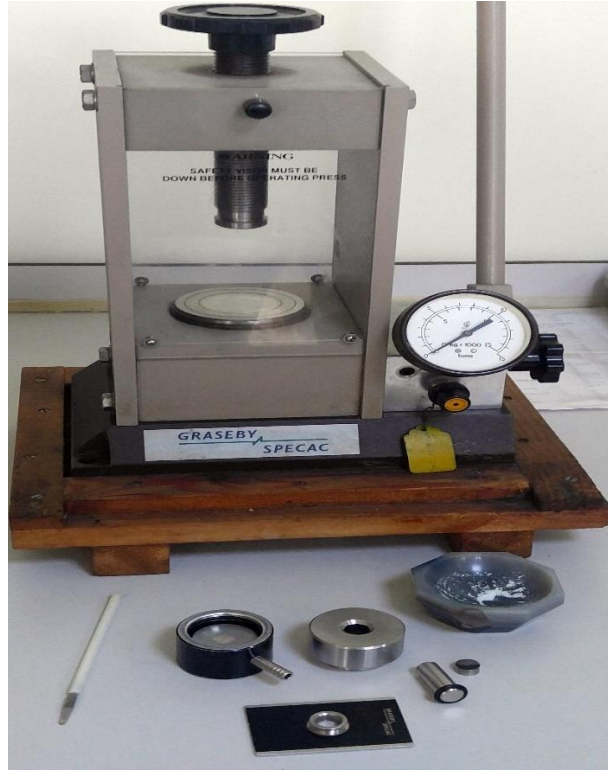
Şekil 4.1. KBr ile disk hazırlamada kullanılan aparatlar ve basınç uygulama cihazı
