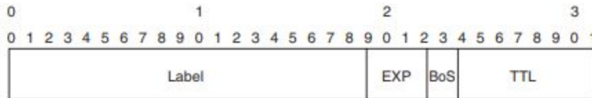
Şekil 4: MPLS etiketi yapısı
